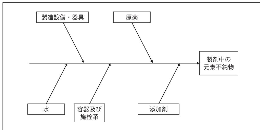
図 製剤の製造において用いられる典型的な原料・資材、製造設備・器具及び構成成分の例<sup>2</sup>
